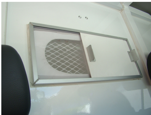
Foto: Ventanilla del vehículo que permite visibilidad desde la cabina al espacio donde se encuentran las personas detenidas y viceversa.
